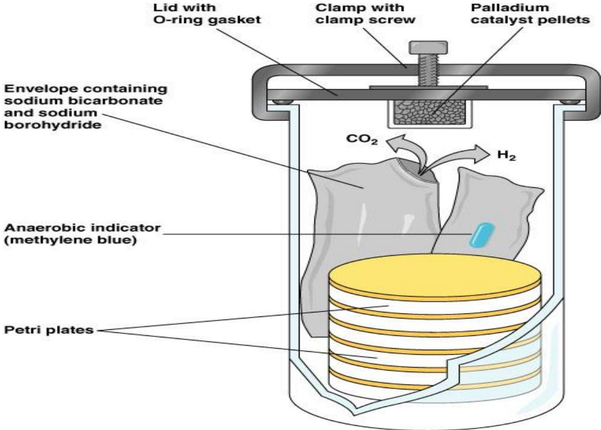
Fig. 17 Anaerobic jar.
