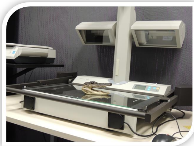
Obr. 5. A3 Skener Minolta. Umožňuje skenovanie väčších predlôh, časopisov či skrípt. Je možné skenovať (fotiť) 3D predmety.
